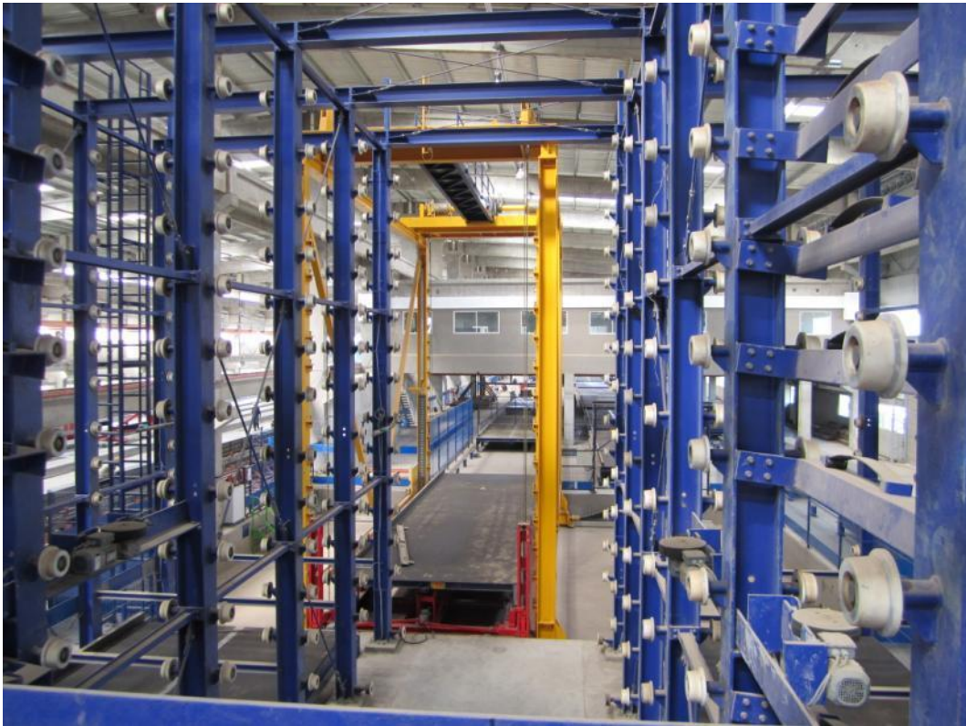
Abb. 13: Die Paletten werden über Reibräder und einen Zahnstangenschieber ein- und ausgefahren
