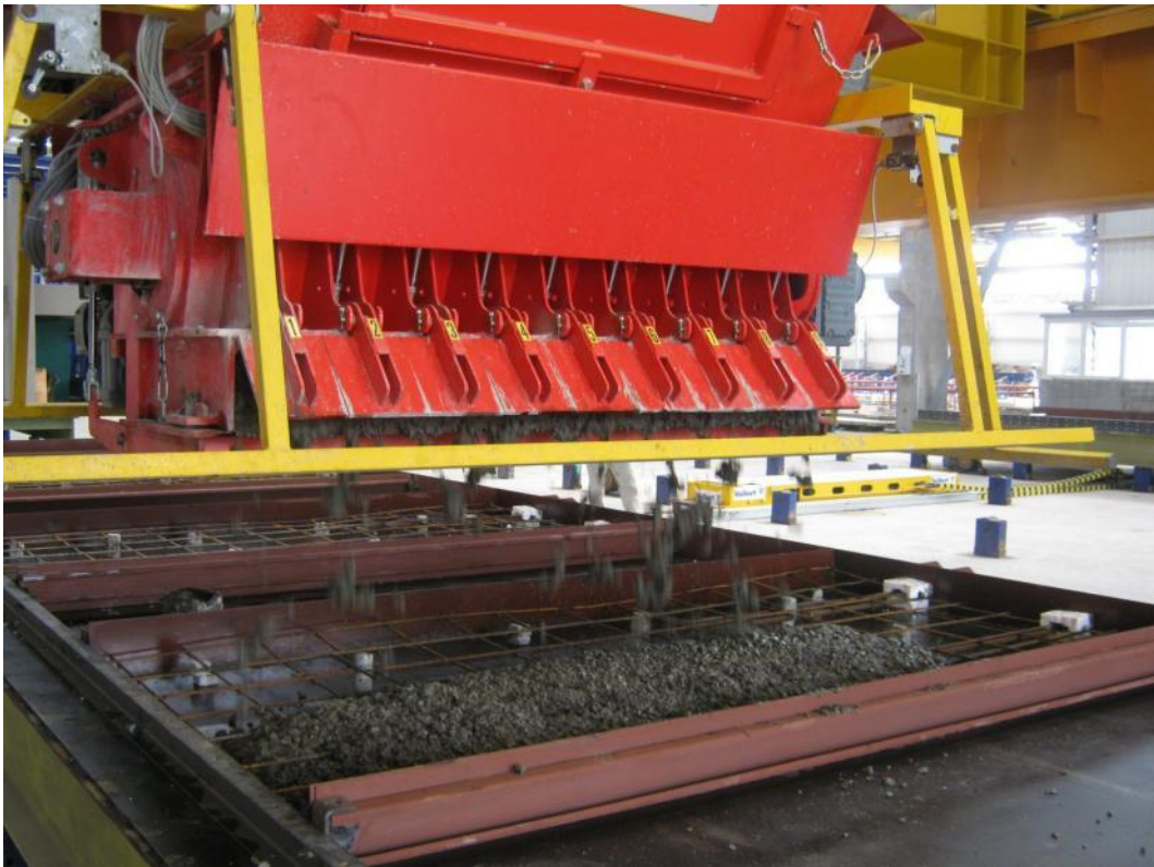
Abb. 8: Einbringen des frischen Betons auf die Palette
