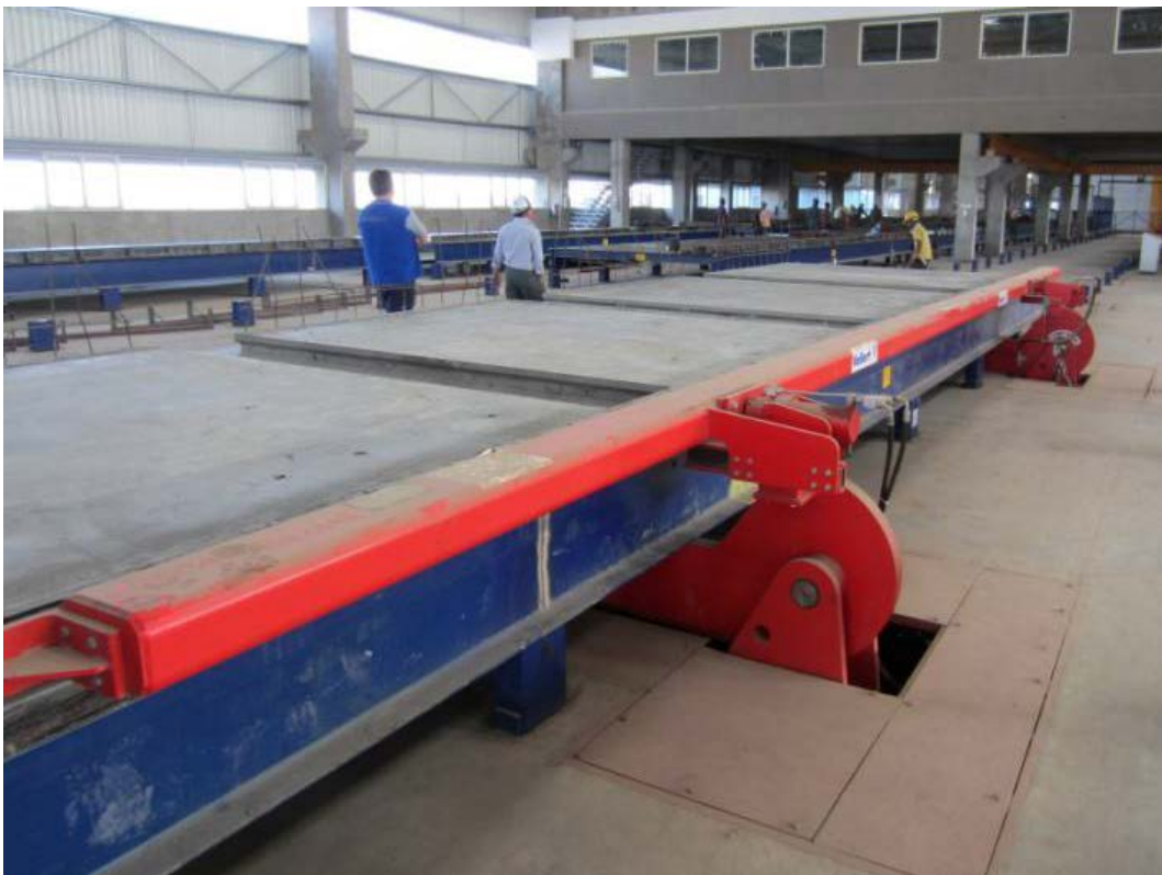
Abb. 16: Kipptisch zum Abheben der Massivwände und -decken
