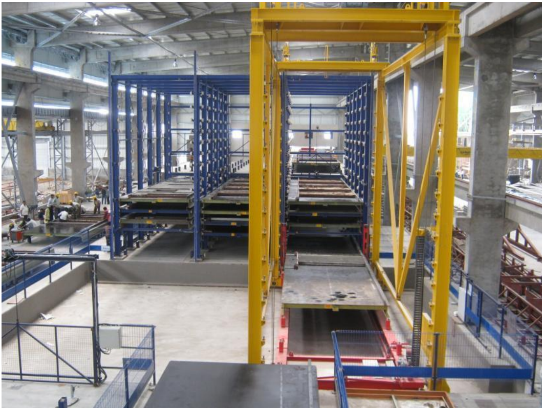
Abb. 12: Regalbediengerät zum Ein- und Auslagern der Paletten in die Härtekammer
