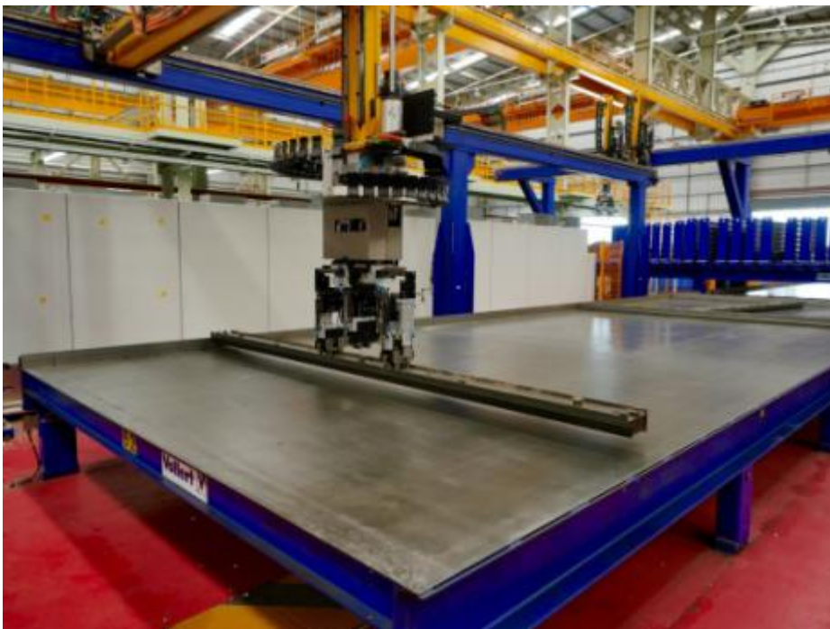
Abb. 2: Das Vorplotten der Konturen und das Einpositionieren der Abschalssysteme erfolgen CAD-/CAM-gesteuert durch einen SMART SET Schalungsroboter
