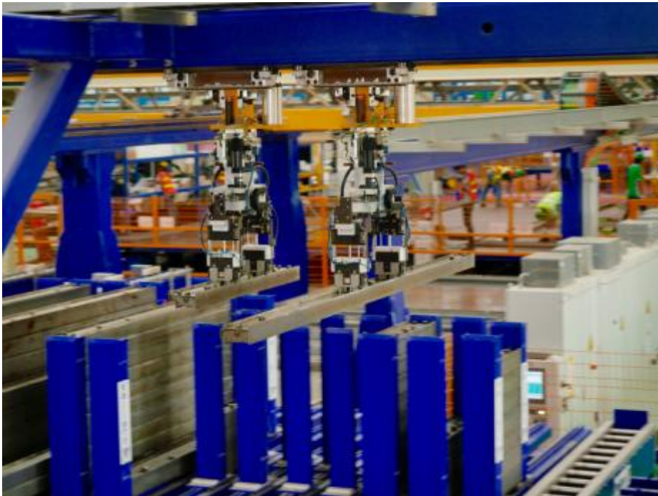
Abb. 1: Ein Magazinierroboter mit Zwillingsgreifern sorgt für einen simultanen Ein- und Auslagervorgang
