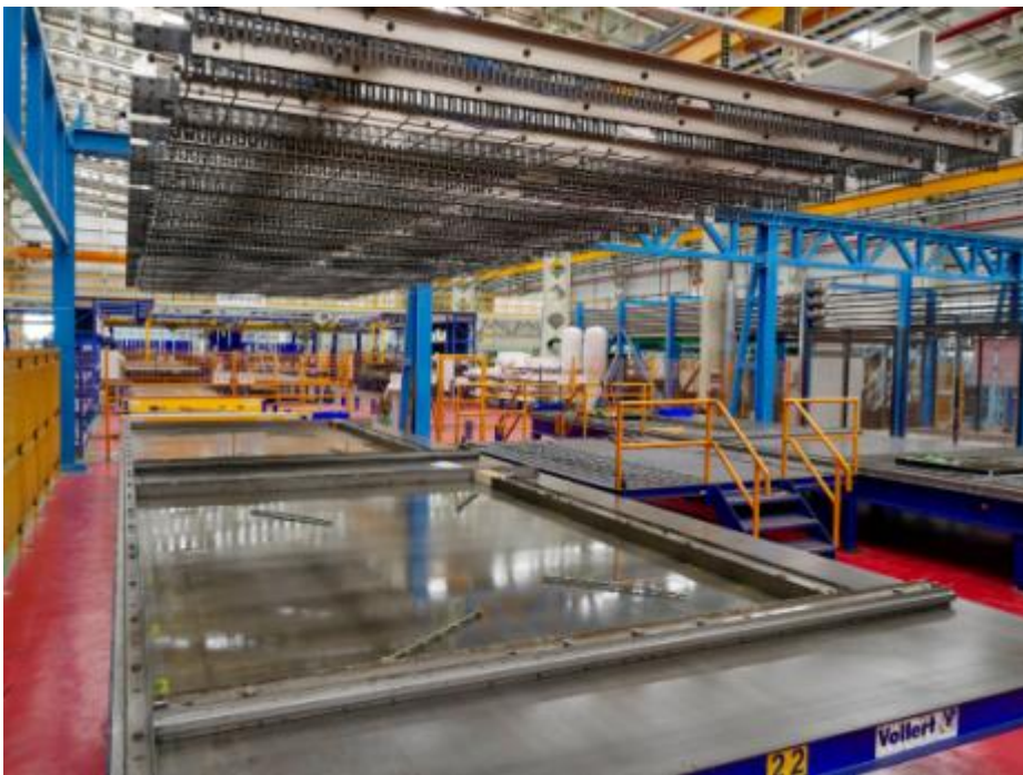
Abb. 4: Bewehrungsmatten als auch Gitterträger werden über eine vollautomatische AWM-Bewehrungsanlage eingebracht
