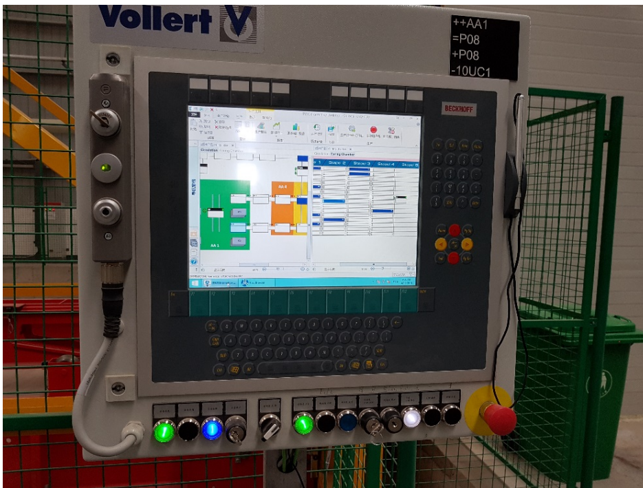
Bild 6 Das MES-Produktions- und Lagerleitsystem steuert und analysiert sämtliche Arbeitsstationen und Anlagenprozesse.
