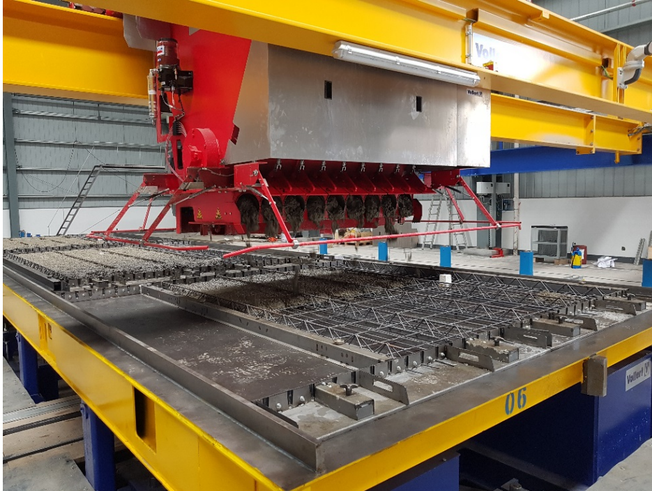
Bild 5 Präzises Auftragen des Betons durch einen SMART CAST Automatik-Betonverteiler.
