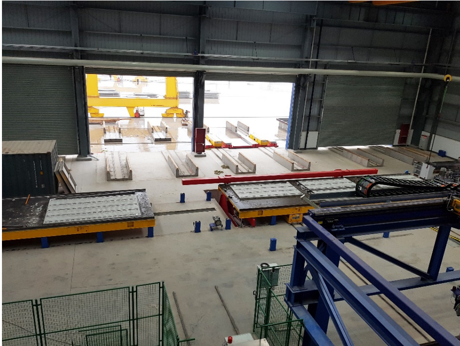
Bild 9 SMART LOGISTIC Ausfahrhubwagen verbinden den Verladebereich mit den großzügigen Außenlagerflächen.
