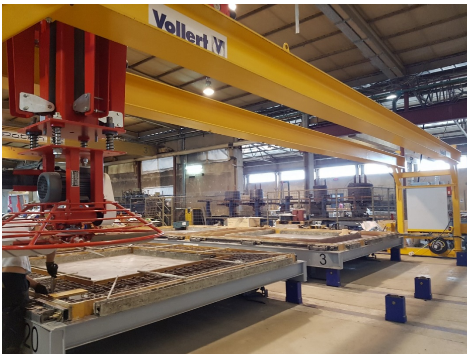
Bild 6 Betonglättstation in Portalbauweise sorgt für Sichtbetonoberflächen und die geforderte Premiumqualität.
