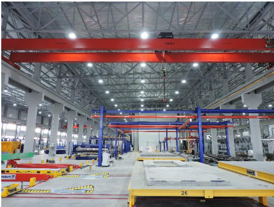
Bild 1 MOTUS Stahlbeton-Hohldecken und die für das Bausystem notwendigen Massiv- und Sandwichwände werden bei EGI parallel produziert.
