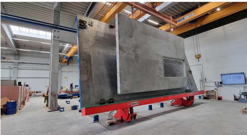
Bild 11: Das vertikale Abheben der Wände übernimmt eine Vario TILT Hochleistungs-Kippstation.
