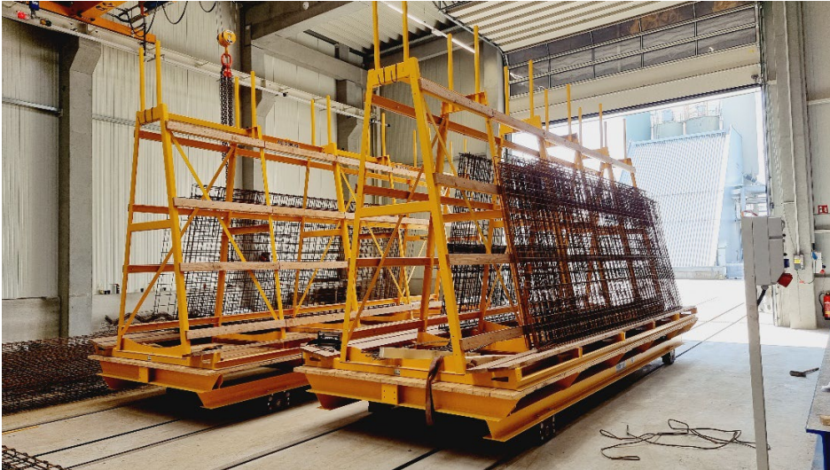
Bild 10: Transportwagen dienen Bewehrungsmatten an.
