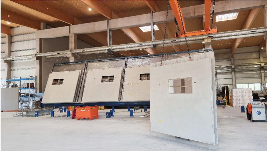
Bild 9: Das vertikale Abheben der Doppelwände erfolgt über eine VARIO TILT Kipstation.
