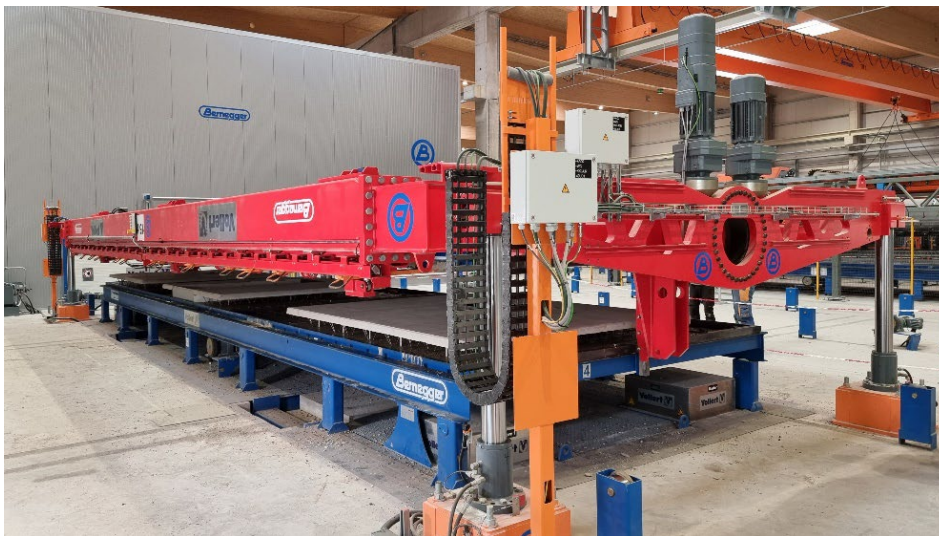
Bild 6: In der Doppelwandfertigung sorgt ein stationäres VARIO TURN Palettenwendegerät einen einfachen teilautomatischen Wendeprozess.
