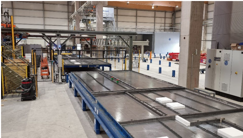
Bild 4: Einbauteile wie Steckdosen und Fensterrahmen sowie die Bewehrungsergänzung werden manuell gesetzt.
