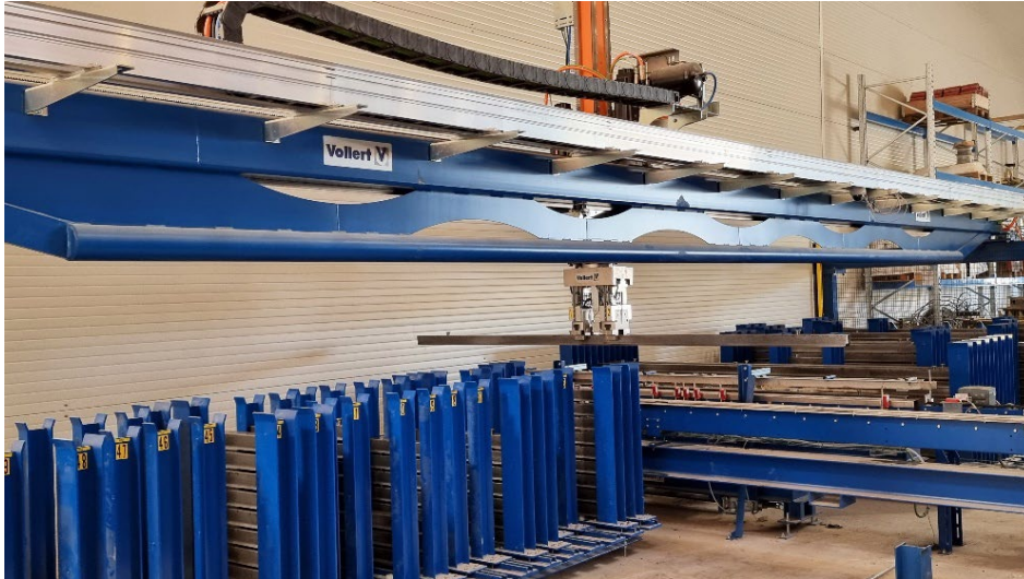
Bild 3: Ein SMART STORE Magazineroboter übernimmt die Zwischenlagerung der Abstellprofile in die Lagermagazine bzw. das Auslagern auf die Zuführstrecke zum nächsten Einschaltvorgang.
