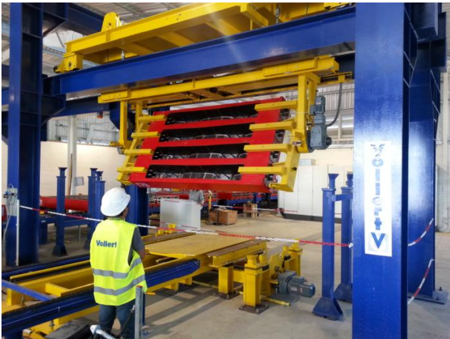
Abb. 10: Eine Wendetraverse verfährt die entspannte Betonform in einen Auslaufbereich, dreht diese um 180 Grad, bevor über eine elektrische Hubvorrichtung der Ausschlagvorgang durchgeführt wird
