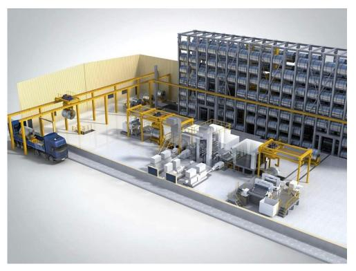
Die Hydro Aluminium Rolled Products GmbH modernisiert ihr Walzwerk in Grevenbroich auf höhere Produktqualitäten. Mit einem lückenlos vollautomatischen Transport im gesamten Walzwerk und bei der Be- und Entladung der Lkw sorgt Vollert Anlagenbau für das sichere Handling der empfindlichen Coils in Litho-Qualität. Das neue Hochregallager bietet Platz für 336 Aluminiumcoils mit einem Gesamtgewicht von 4.000 Tonnen. Grafik: Hydro.
