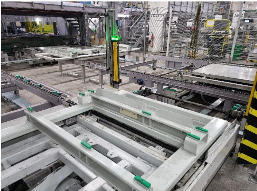
**Photo 2 — Extension du convoyeur à chaîne transversal**
